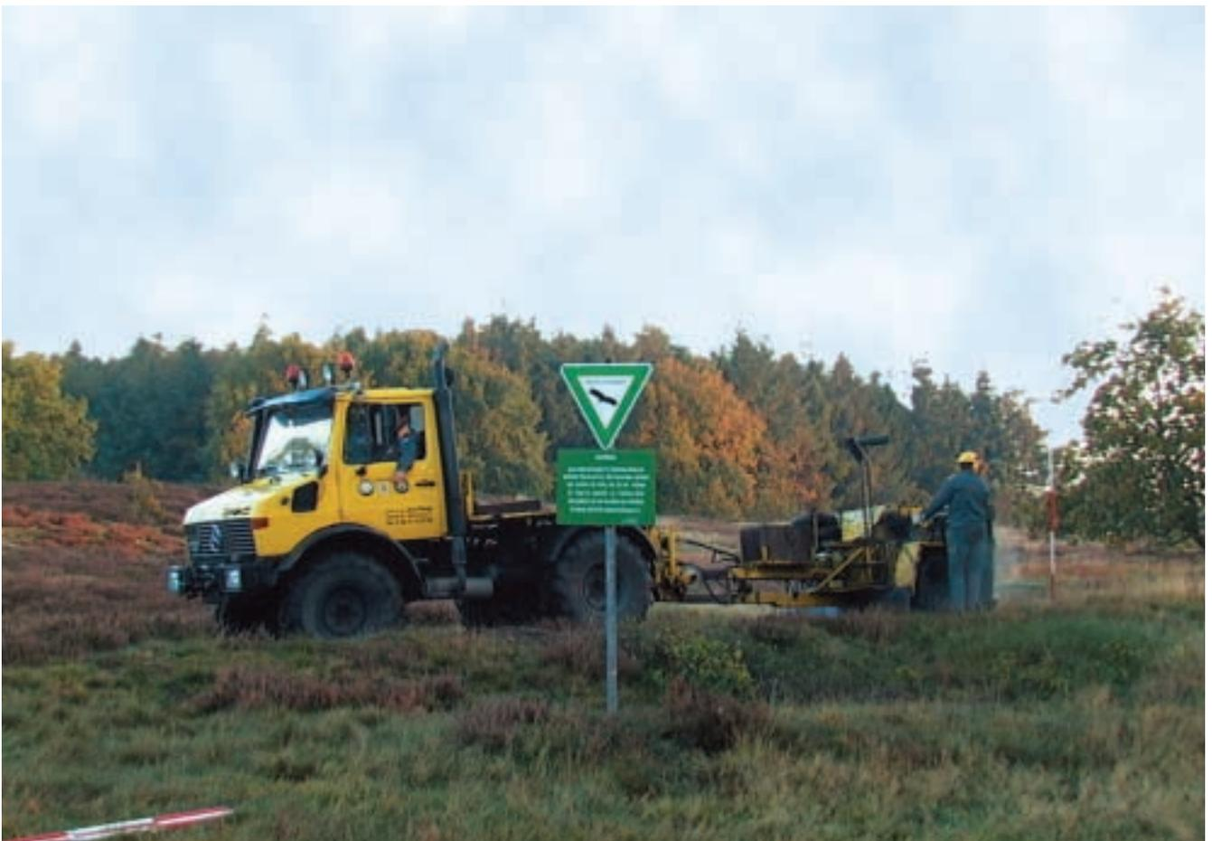
Abbildung 7: Die Stubbenfräse wird von einem schweren Fahrzeug gezogen und ist nur begrenzt manövrierfähig. Sorgwohlder Binnendünen am 19.10.04
